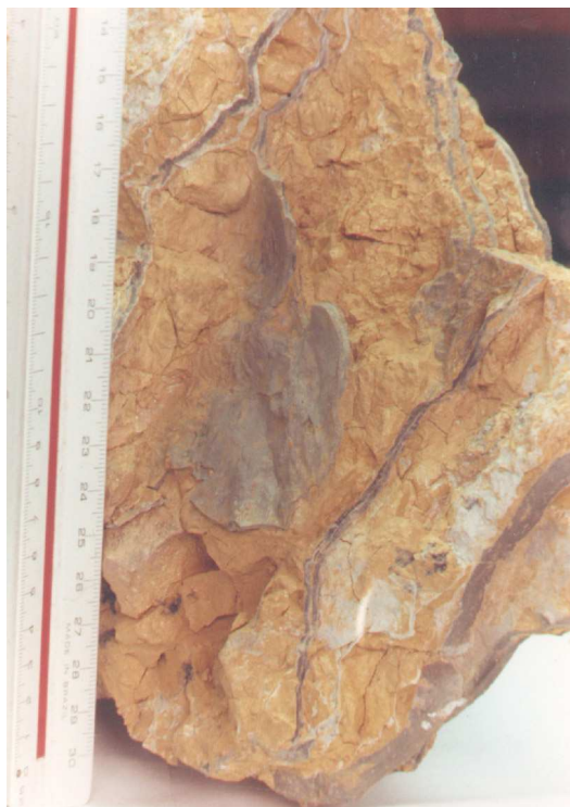
Foto 1 – Camadas de injeção de calda de cimento em sedimento terciário de São Paulo (Apud. Guimarães, J.D.)
