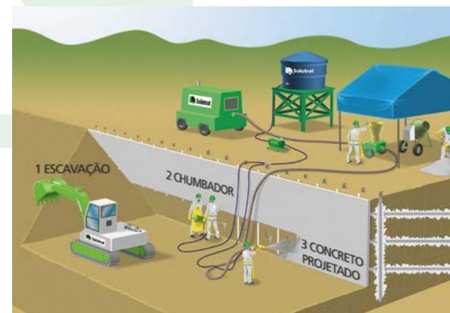
Figura 5 - Fases construtivas em corte. Exemplo de escavação mecanizada.
