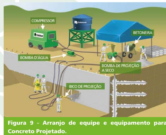
**Figura 9 - Arranjo de equipe e equipamento para Concreto Projetado.**
