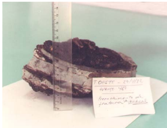
Foto 2 - Camadas de inyección de lechada de cemento en suelo aluvionar de São Paulo consolidado por inyección (Apud. Guimarães, J.D.)
