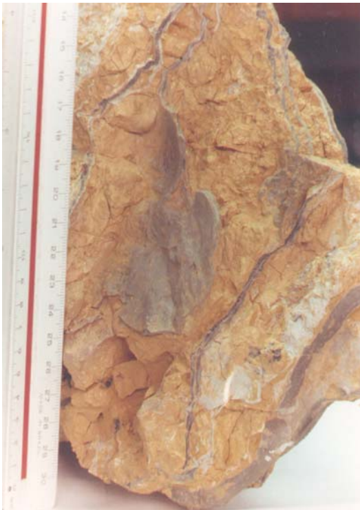
Foto 1 – Camadas de inyección de lechada de cemento en sedimento terciario de São Paulo (Apud. Guimarães, J.D.)
