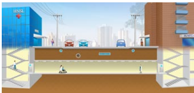
Figura 9 - Túnel sob via pública para interligação entre prédios hospitalares, com 3,64m de diâmetro
