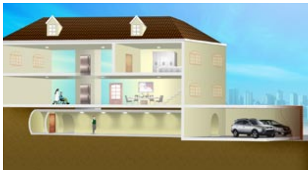
Figura 6 - Túnel residencial para acesso a elevador, com 3,05m de diâmetro
