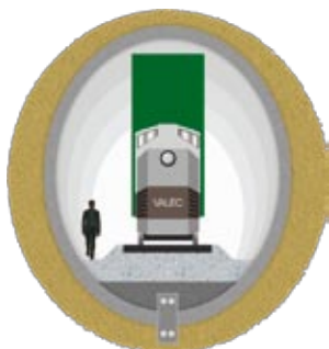
Figura 8 - Túnel ferroviário sob rodovia, com 60,0m 2
