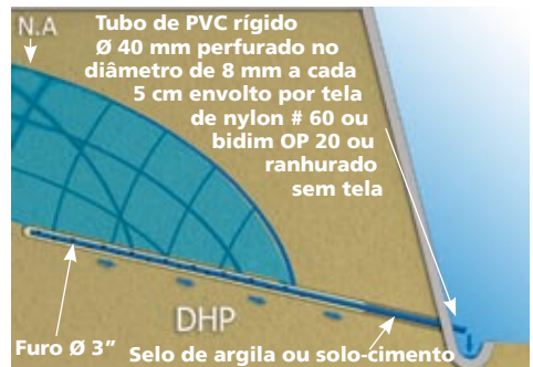
Figura 12 - Dreno Sub-Horizontal Profundo
