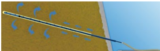
Figura 20 - Introdução do êmbolo e injeção de água
