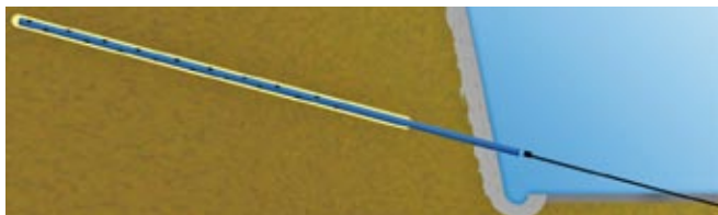
Figura 19 - Folga entre êmbolo e tubo de 1 mm
