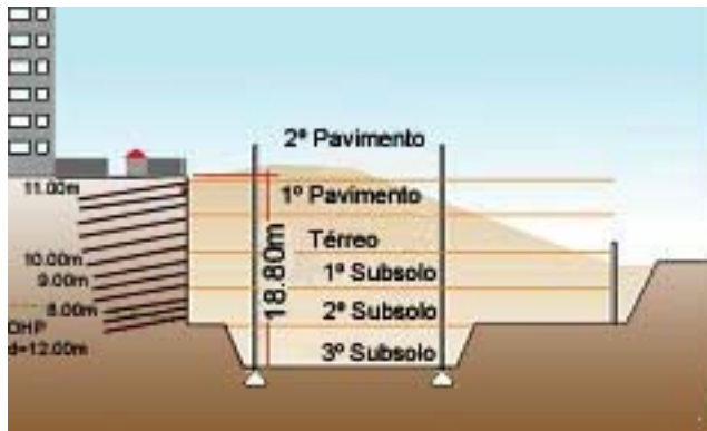
Figura 21 - Corte esquemático do projeto, R. Samia Haddad
