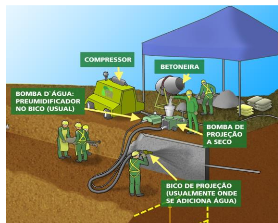
Figura 34 – Arranjo de equipe e equipamento para concreto projetado
