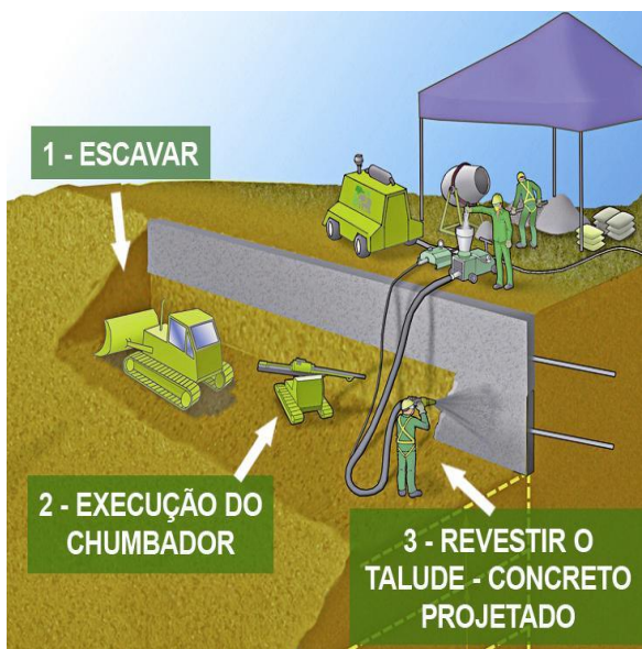
Figura1 – Sequência de execução
