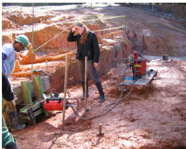
Figura 6. Montagem do ensaio de arrancamento. Os grampos tinham comprimento total de 3,0 m e comprimento livre de 1,0 m. Utilizou-se uma estrutura de suporte junto à face do talude
