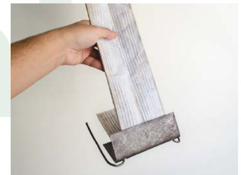
Figura 5 - Detalhe de ponteira metálica presa ao geodreno.
