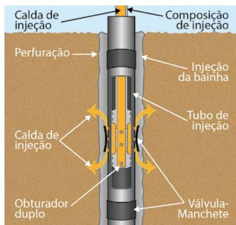
Figura 3 - Detalhe do obturador de injeção para Microestaca.
