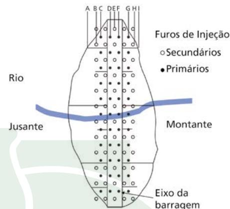
Figura 7 - Tratamento de fundação de barragem.
