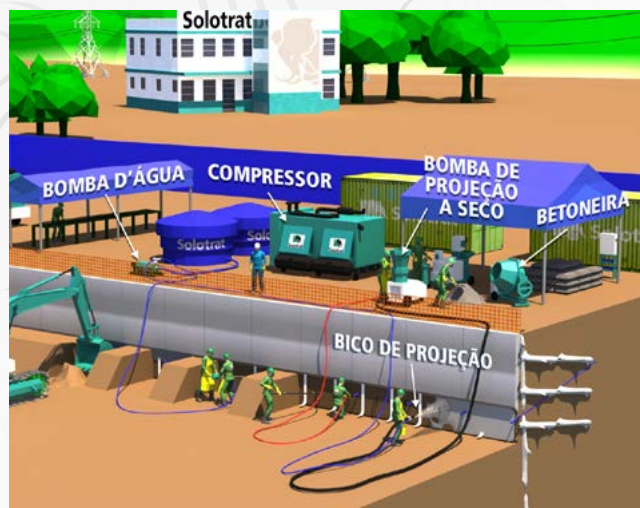
Figura 9 - Arranjo de equipe e equipamento para Concreto Projetado.
