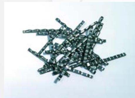
**APLICAÇÃO DO CONCRETO REFORÇADO COM FIBRAS METÁLICAS STEEL JET**
