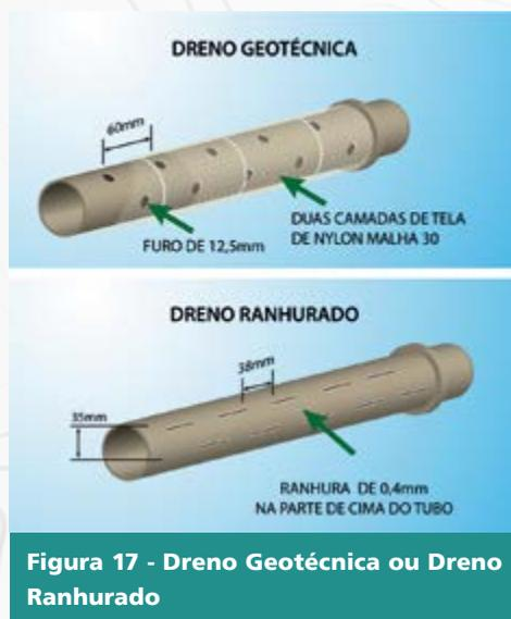
Figura 17 - Dreno Geotécnica ou Dreno Ranhurado
