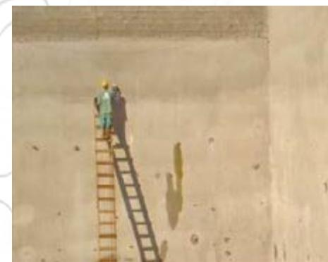
Figura 25 - Leitura de Deformação Horizontal.
