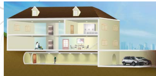
Figura 6 - Túnel residencial para acesso a elevador, com 3,5m de diâmetro.
