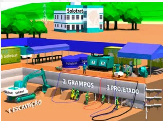
Figura 5 - Fases construtivas em corte. Exemplo de escavação mecanizada.
