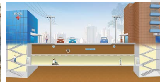
Figura 9 - Túnel sob via pública para interligação entre prédios hospitalares, com 3,64m de diâmetro.
