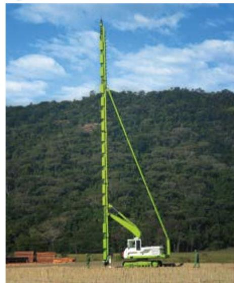
Figura 4 - Equipamento em serviço de cravação de geodrenos.
