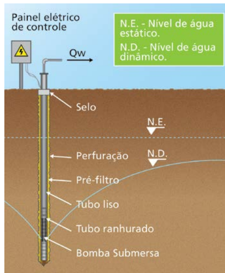
Figura 1 - Montagem geral do rebaixamento por poços com bomba submersa
