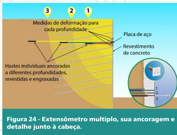
Figura 24 - Extensômetro múltiplo, sua ancoragem e detalhe junto à cabeça.
