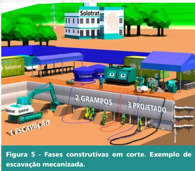
Figura 5 - Fases construtivas em corte. Exemplo de escavação mecanizada.
