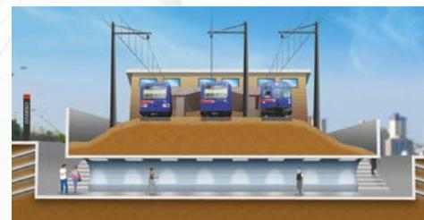
Figura 10 - Túnel urbano de pedestres sob ferrovia, com seção de 10,0m².
